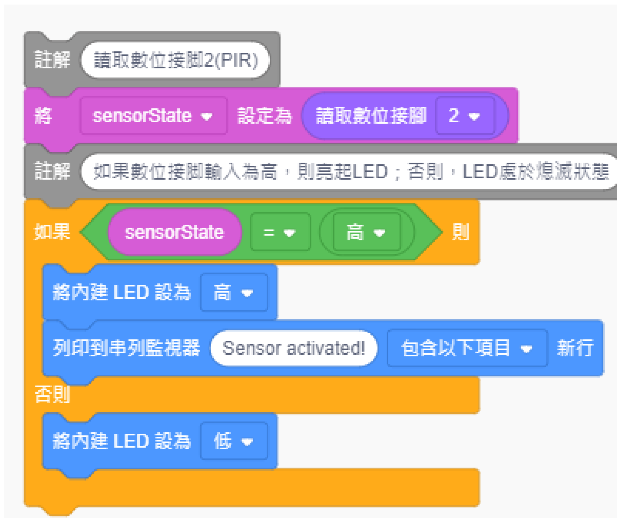
圖 錯誤！所指定的樣式的文字不存在文件中。-6 Arduino + PIR sensor 積木程式碼
