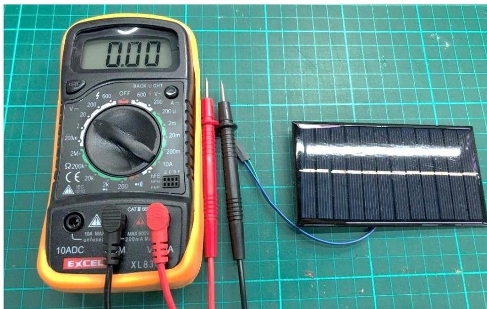
6c. 量度位置固定後，可觀察萬能表上的讀數。在室內的環境，太陽能板所產生的電壓範圍大概在2.9v至4.0v內。
