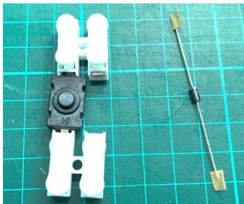
4. 將防逆流二極管輕輕彎曲，按壓綫路接駁器把二極管卡進金屬片。注意：二極管正負方向，負極（符號：-）與電源開關接駁；正極（符號：+）與太陽能板正極接駁。
