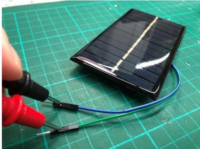
6d. 當發現讀數出現負數值時，代表探測針與電綫的正負極相反。同學只需將探測針交換正負極後，再一次量度電綫（電綫位置需保持不動）就會出現正數了。所以，可根據探測針與電綫的量度讀數知道電綫的正負極。
